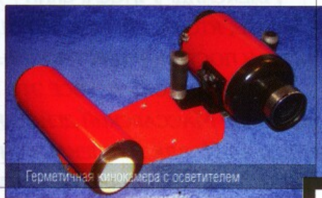
Герметичная кинокамера «Нереида» и герметичные фотоаппараты «Аквакон-1» и «Аквекон-2»
