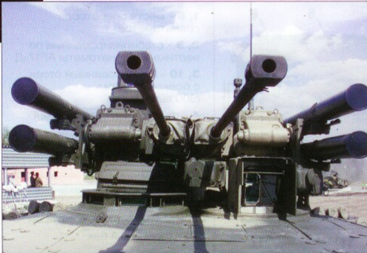
Основное оружие БМПТ – спаренные 30-мм автоматические пушки 2А42
