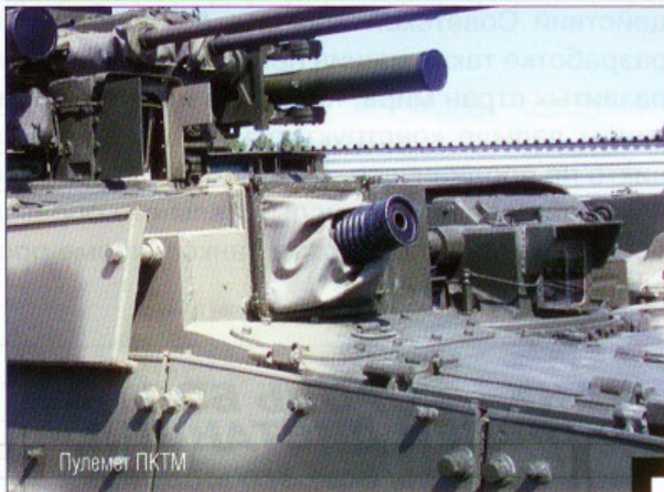
Основное оружие БМПТ – спаренные 30-мм автоматические пушки 2А42
